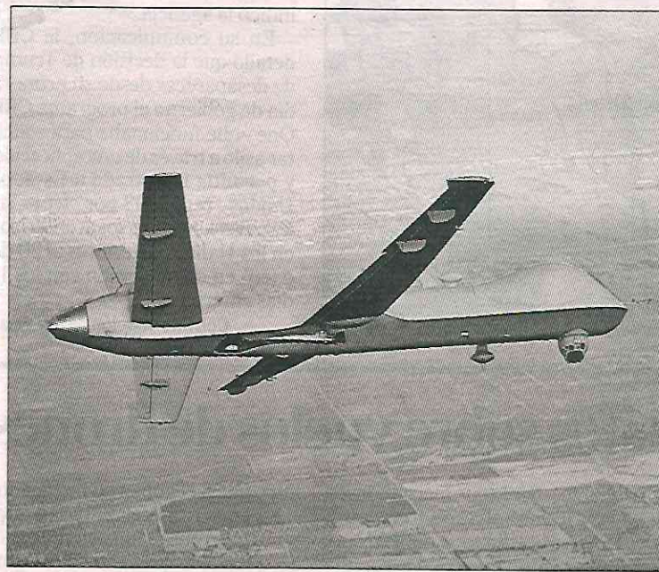
▲ El MQ-9 Reaper es un dron de combate no tripulado desarrollado por General Atomics para la Fuerza Aérea de Estados Unidos. Es muy potente, prácticamente un avión pero sin tripulación, con la capacidad de llevar armas. Es utilizado para misiones de ataque, vigilancia y reconocimiento. Foto tomada de X
