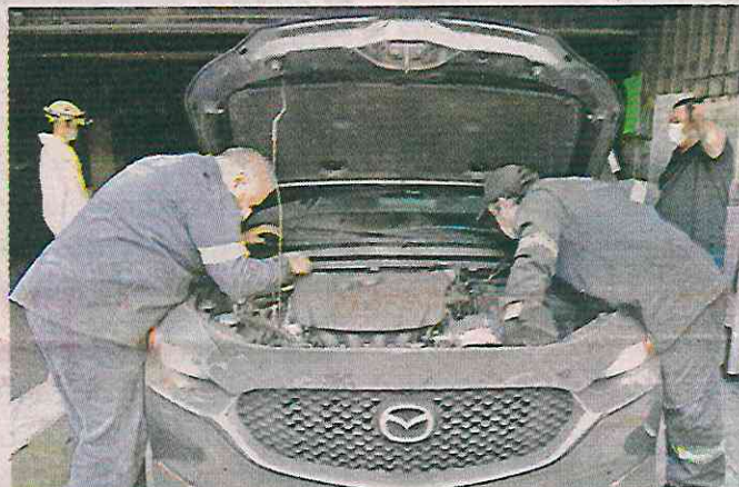
Las unidades eran sometidas a inspección para descartar fugas en las mangueras.
